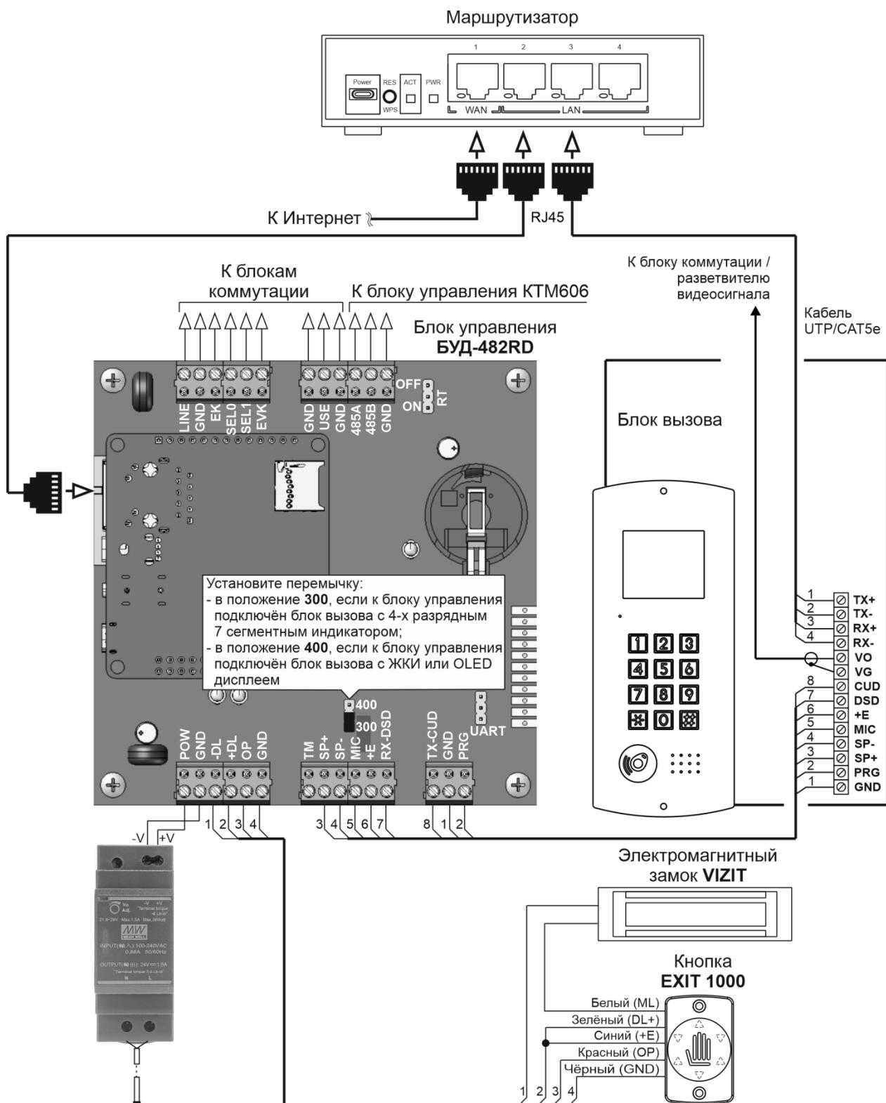
Рисунок 9.1 – Схема соединений блока управления, блока вызова, блока питания, электромагнитного замка и кнопки EXIT 1000
