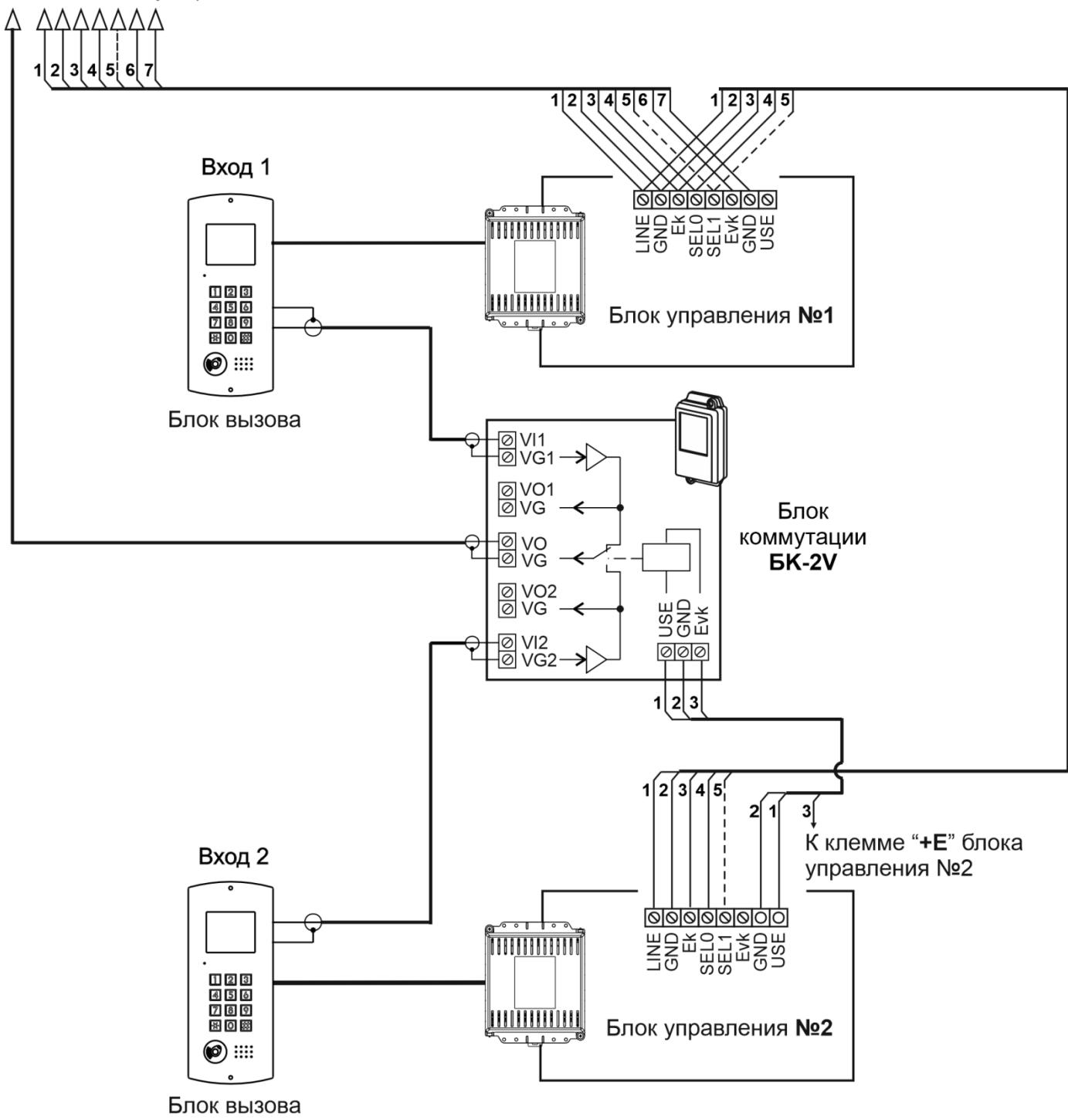
Рисунок 9.11 – Схема соединений блоков управления с блоком коммутации BK-2V
