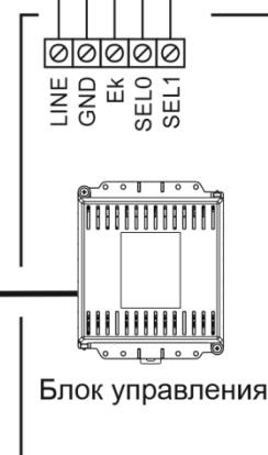
Рисунок 9.2 – Схема соединений управления с блоками коммутации БК-4М
