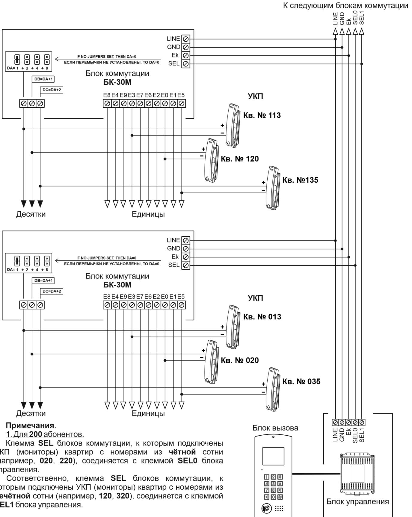
Рисунок 9.4 – Схема соединений управления с блоками коммутации БК-30М
