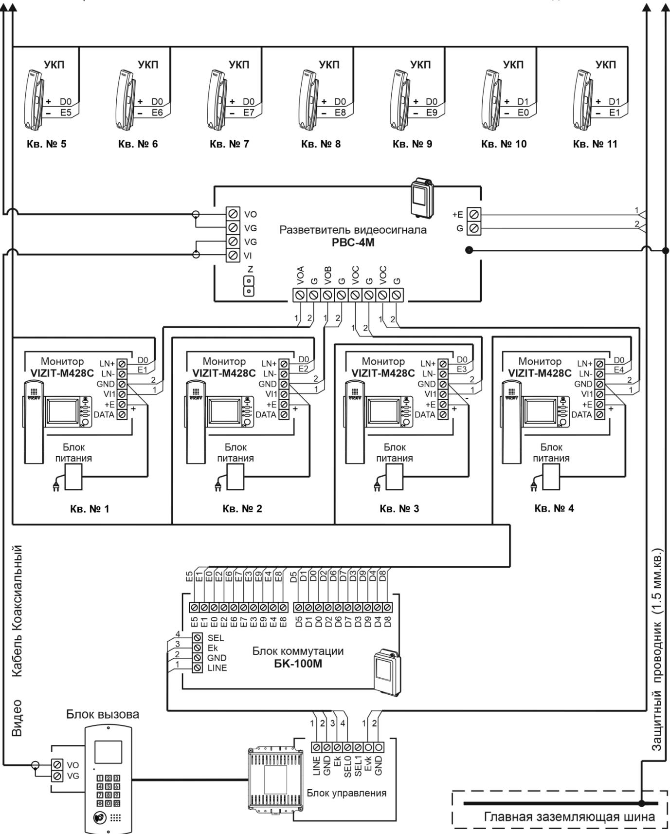
Рисунок 9.9 – Схема соединений блока управления с разветвителями видеосигнала РВС-4М
