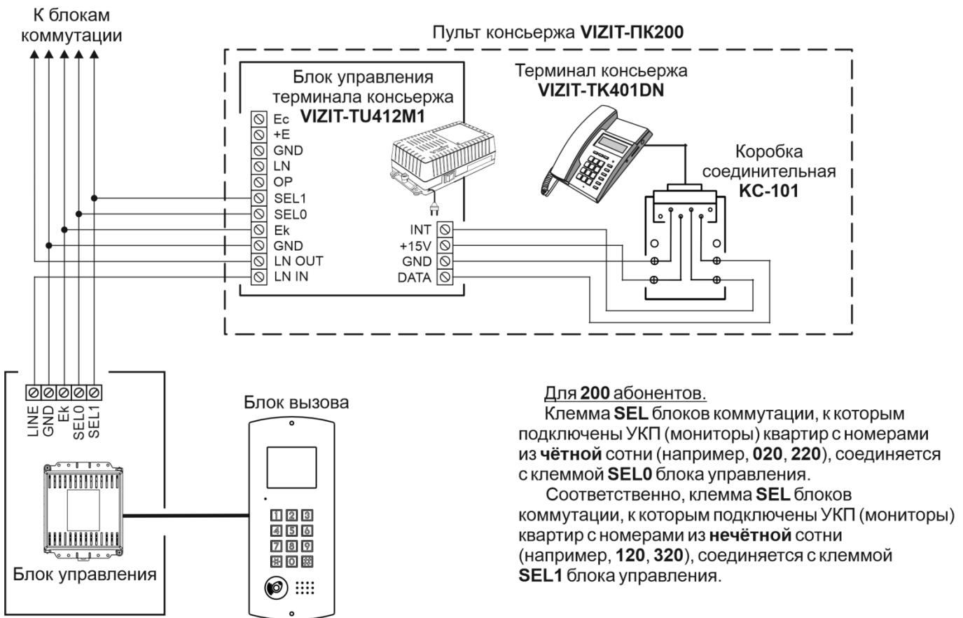
Рисунок 9.7 – Схема соединений блока управления с пультом консьержа VIZIT-ПК200 в составе 200-квартирного домофона
