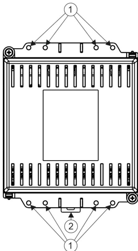
(1) - Отверстия для крепления блока коммутации на стену.
